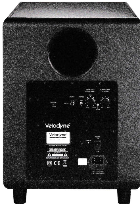
Der Subwoofer erlaubt auch den normalen Betrieb mit Cinchkabel, zudem befindet sich hinten eine fette Bassreflexöffnung.
