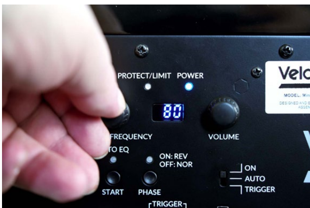
Analoge Drehregler steuern die obere Grenzfrequenz und den Pegel, das Display zeigt den jeweiligen Wert
